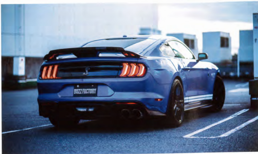
大型のリアディフューザーや音量切り替え用の電子制御バルブを備えたデュアルエグゾーストを標準装備。テールライトはLEDのシーケンシャルタイプとなっている。
