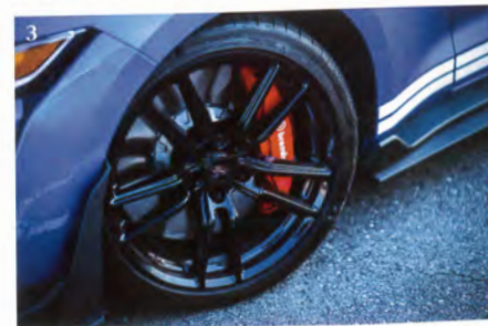
1/標準のリアスポイラー。オプションでカーボンファイバーGT4トラックウイングも用意されている。2/オプションのレカロ製レザートリムシートを装着。3/ハイグロスブラックの20インチアルミホイールの内側にはフロントには6ピストン、リアには4ピストンの赤いブレンボ製キャリパーがのぞく。タイヤはフロント305/30ZR20、リアは315/30ZR20のミシュランパイロットスポーツ4S。4/写真のものははじめハットだけでも6種類をラインアップ。価格は各4800円(税別)
